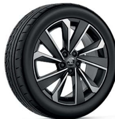
Riegel juodi metalizuoti, šlifuoti 7J x 17" ET51, skirta 215/45 R17 6VE 071 497A FL8 6VA 071 497A FL8*
