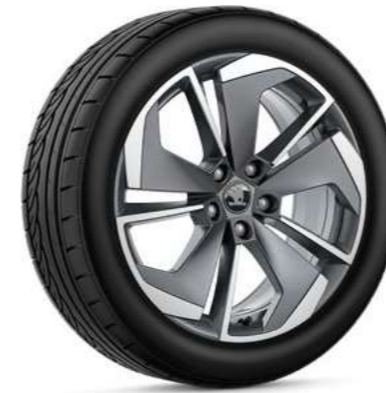
Comet lengvojo lydinio ratlankiai antracito spalvos metalizuoti, šlifuoti 7.5J x 18" ET48, skirti 225/45 R18 5E3 071 498A HA7 5E3 071 498AL HA7*
